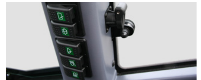
Zusammengefasste Schalterleiste, Steckdose mit Dauerstrom
