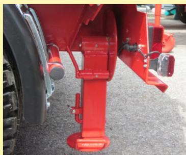
verstellbar und schwenkbare Stützen am Fahrzeugheck
