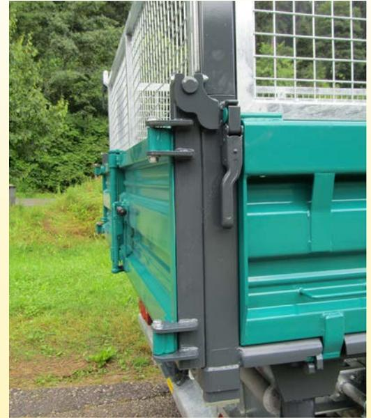
hydr. Heckklappe mit erhöhtem Drehlager
