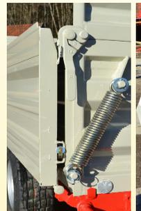
Abklappreinrichtung mit Bordwandhebefedern
