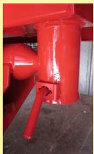
große Kugel u. konische Kugelpfanne mit Überkreuzungssicherung
