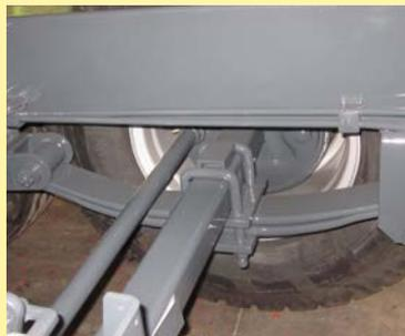
Tandemaggregat mit Parallelfedern und tiefer gelegtem Fahrwerk, Achsen obenliegend
