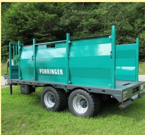
Brücke hydr. nach hinten schwenkbar
