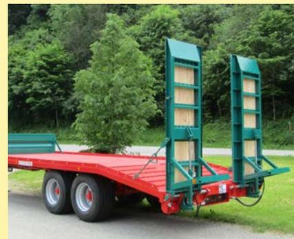
Plattformanhänger hinten abgeschrägt 1500mm /10° mit hydr. Auffahrampen
