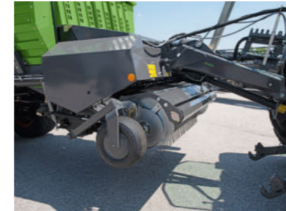
Eine hydraulische Knickdeichsel verleiht der Pick-Up des Tigo S bis zu 70 cm Bodenfreiheit.
